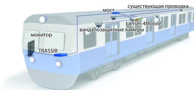
Рисунок 8.1 - Примерная схема оснащения электропоезда системой видеонаблюдения
